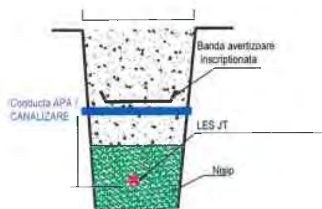
Intersecție între LES și o conductă de APA / CANALIZARE conf. NTE 007/08/00
